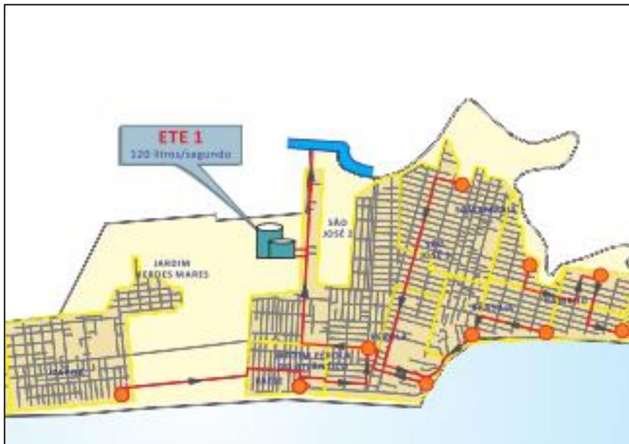
Figura 4 – Esquema da concepção de distribuição da primeira etapa do Sistema de Esgoto de Itapoá, ETE 1. Fonte: Itapoá Saneamento.
