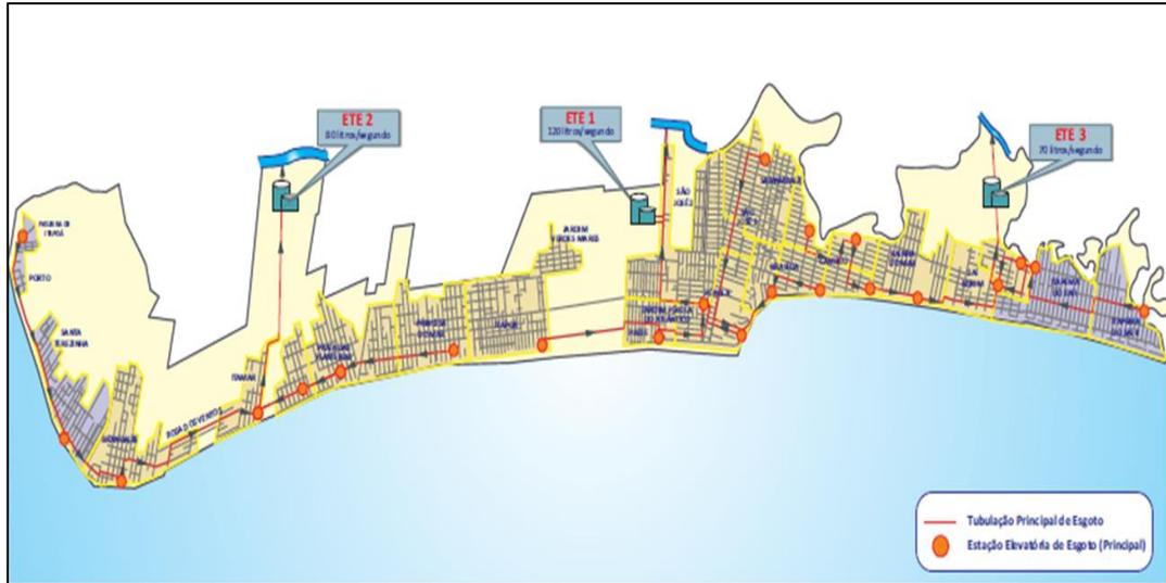
Figura 5 – Esquema da configuração da concepção final do sistema de tratamento de esgoto de Itapoá, ETE 1, ETE 2 e ETE 3. Fonte: Itapoá Saneamento.
